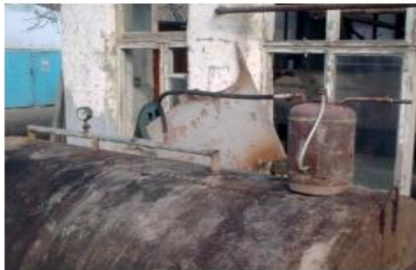
2.3 – rasm. Substratni qo'lda quyish va aralashtirishga hamda bioreaktor ichida substratni qizdirishga ixtisoslashtirilgan biogaz uskunasi.
